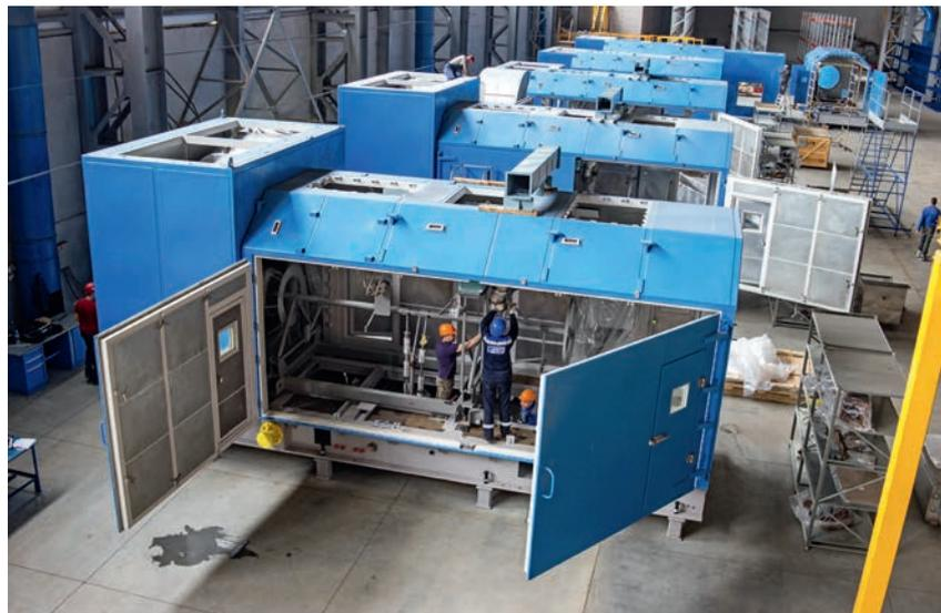
С 2019 г. на заводе «РУМО» началась реновация, в рамках которой создано новое производственное направление – изготовление блочно-модульных конструкций, в том числе для газоперекачивающих агрегатов.
